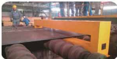
● 某钢厂大型钢板退磁
